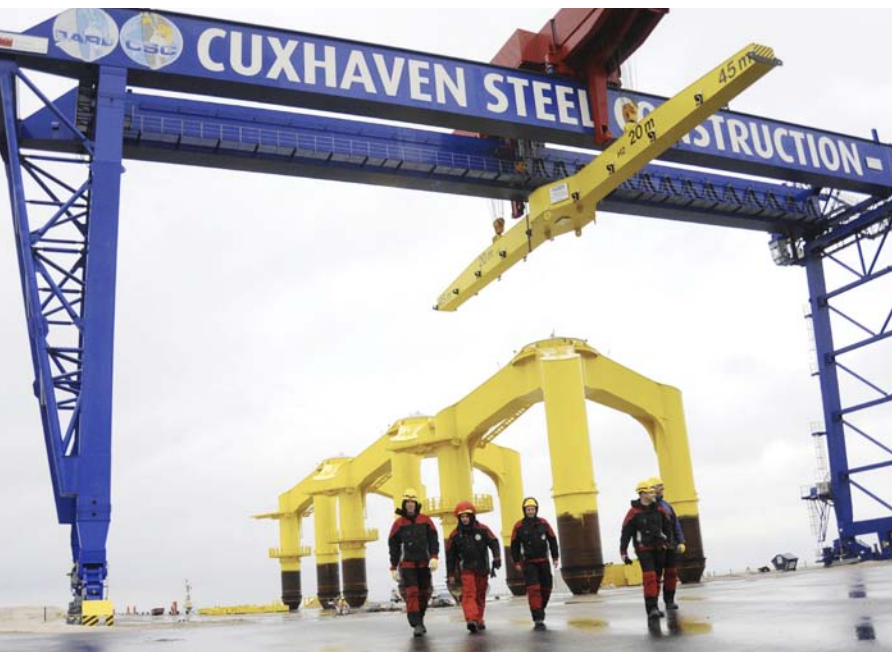
Der Portalkran der Cuxhaven Steel Construction GmbH ermöglicht der Offshore-Branche einen Umschlag von Komponenten bis zu 600 Tonnen.
