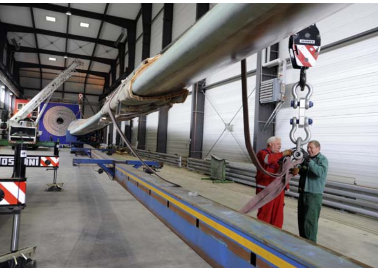
Vorbereitung eines Rotorblatttests im Fraunhofer Institut für Windenergie und Energiesystemtechnik in Bremerhaven.
